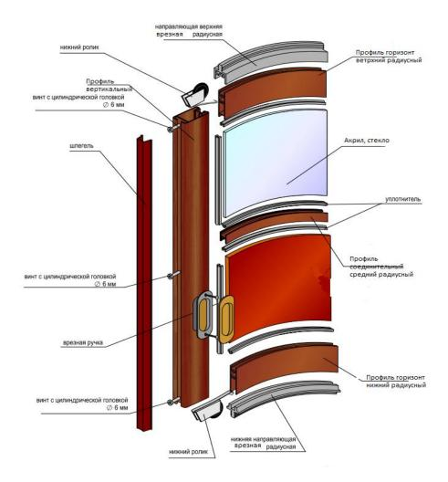
Радиусные двери в шкаф купе устанавливаются на врезные направляющие, используется нижний ролик как вверху, так и внизу. Стопор ставится в верхнюю направляющую. В верху направляющие закрываются фризом/карнизом.
